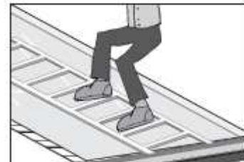
Uwaga! Nie wolno wchodzić na płyty pomiędzy płatwiami!
