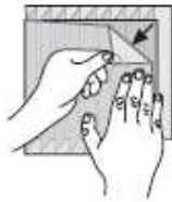
Rysunek 17a. Częściowe lub całkowite zdejmowanie folii ochronnej przed i po montażu
